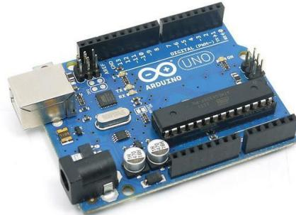
El microcontrolador en la placa Arduino se programa mediante el lenguaje de programación Arduino (basado en Wiring) y el entorno de desarrollo Arduino (basado en Processing). Los proyectos hechos con Arduino pueden ejecutarse sin necesidad de conectar a un ordenador, si bien tienen la posibilidad de hacerlo y comunicar con diferentes tipos de software (p.ej. Flash, Processing, MaxMSP).
